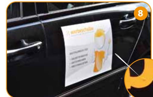
8 Größere Bläschen vorsichtig mit einer Nadel aufstechen (ohne den Lack zu berühren) und die Luft rausdrücken
